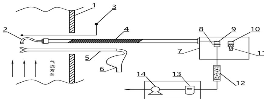
图2 烟道外过滤颗粒物采样及分析测量装置示意图（滤膜）
